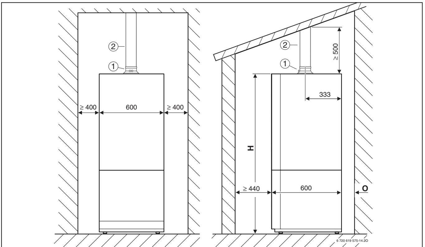
Рис 10 Ø 60/100 мм, наклонная крыша
