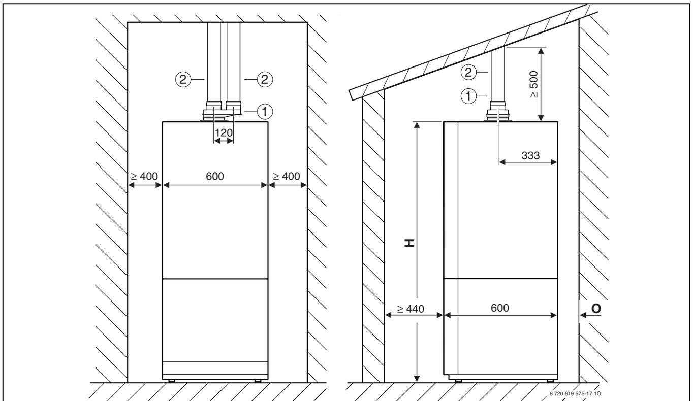
Рис 13 Ø 80/80 мм, наклонная крыша
