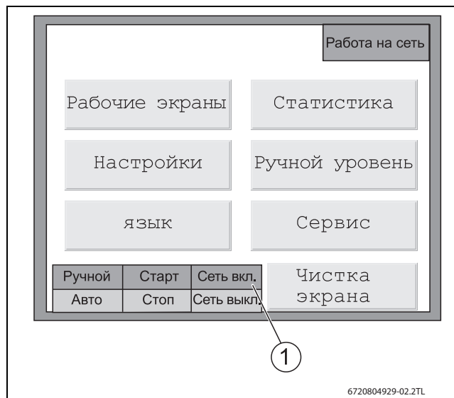
Рис. 34 Включение силового реле генератора
