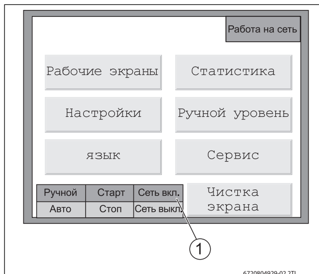
Рис. 31 Включение силового реле генератора
