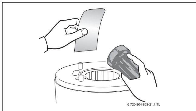
Rasm 52 Иссиқлик блокада қолдиқлар қолган-қолмаганлигини текширинг
